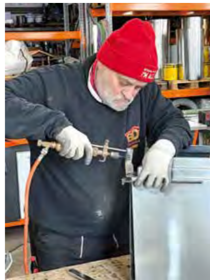
In der Klempnerwerkstatt werden Entwässerungskästen für ein Denkmalschutzprojekt von Hand gefertigt.
