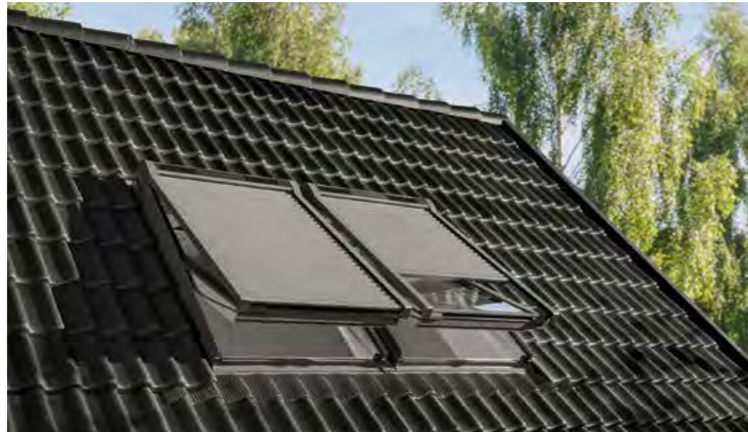
Velux Rollläden der neuen Generation werden direkt auf den Flügel des Dachfensters montiert. Das ermöglicht eine Bedienung des Fensters unabhängig von der Ausfahrposition des Rollladens.
